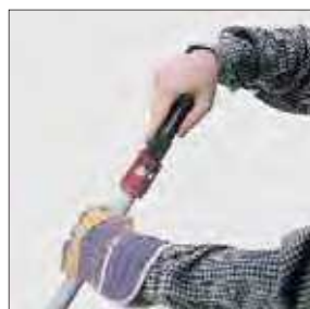
Простое снятие грата с использованием рукоятки
