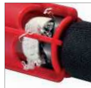
Мощный резец, ориентированный на систему пресс-фитинга
